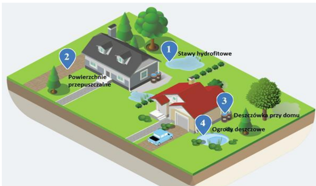
Rys. 4 Propozycje zagospodarowania wody opadowej przy domach jednorodzinnych
