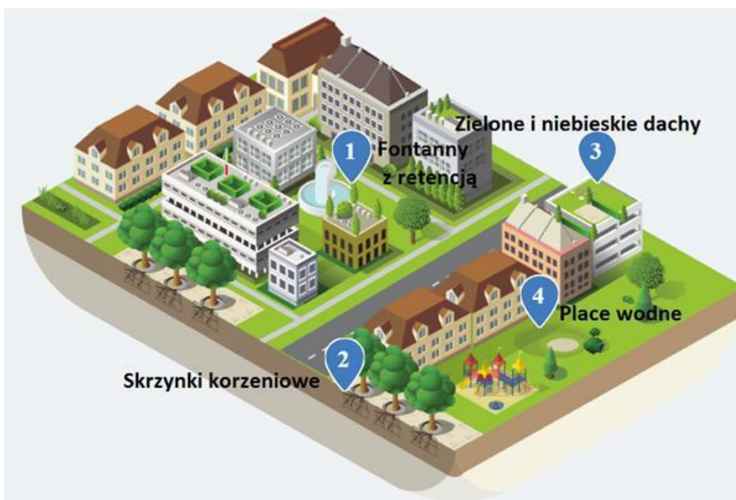
Rys. 5 Propozycje zagospodarowania wody opadowej przy zabudowie zwartej
