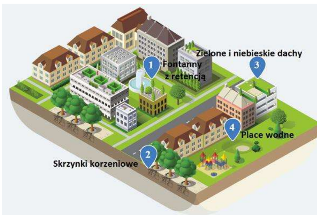
Rys. 5 Propozycje zagospodarowania wody opadowej przy zabudowie zwartej
